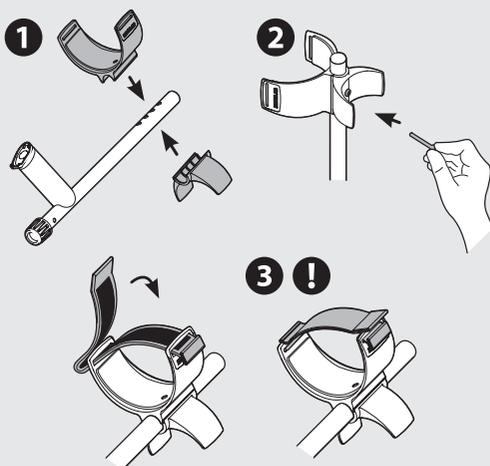
! X-Terra 705 está diseñado para utilizarse con la mano derecha o izquierda indistintamente. Esta imagen muestra la correa de velcro atada por fuera en el brazo izquierdo.
