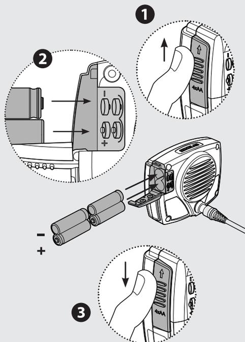
**!** Si el detector no se enciende correctamente, compruebe la orientación de las pilas. El detector no se dañará si las pilas se introducen incorrectamente.
