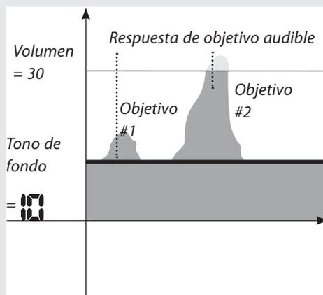
Si el Tono de fondo está configurado a un valor positivo, lo suficiente alto para que pueda oír un leve zumbido, el detector emitirá señales de objetivo y un sonido de Tono de fondo. Se recomienda que utilice un Tono de fondo que sea muy bajo; un Tono de fondo alto puede esconder las señales de objetivos pequeños.
